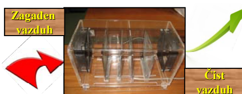
Slika 42. Laboratorijski elektrostatički filter
